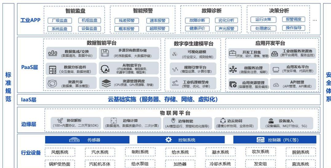
图 1 苏畅工业互联网平台技术架构
