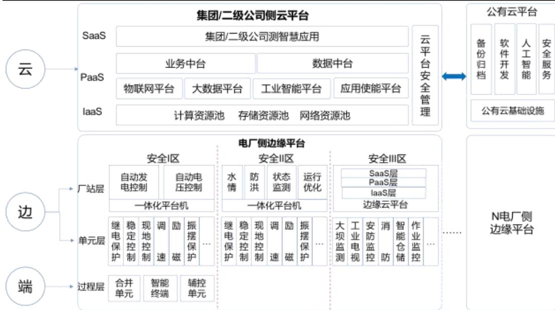
图 2 多源多态多级工业互联网生态平台总体架构
