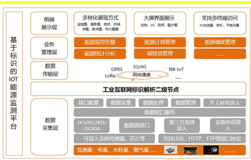
图 1 能源检测平台架构
