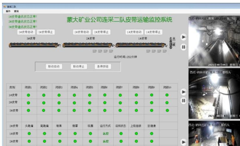
图 8 掘进工作面皮带运输监控界面
