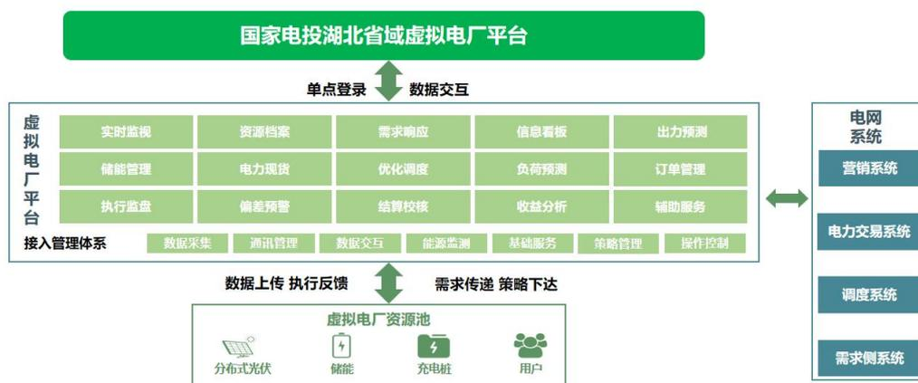
图 1 国家电投湖北省域虚拟电厂平台架构图
