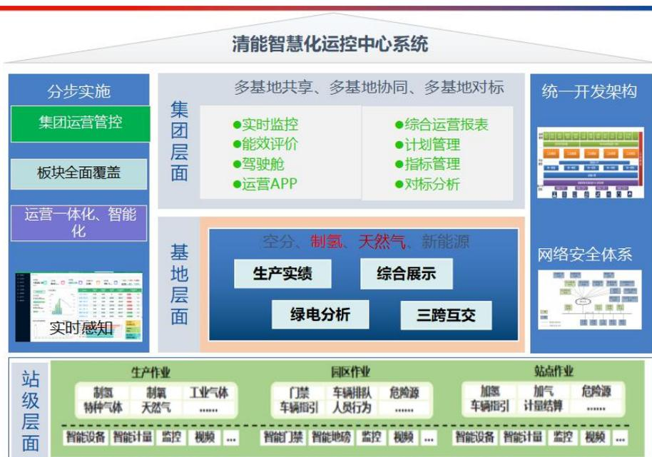
图 2 宝信清能智慧化运控中心系统整体架构示意图
