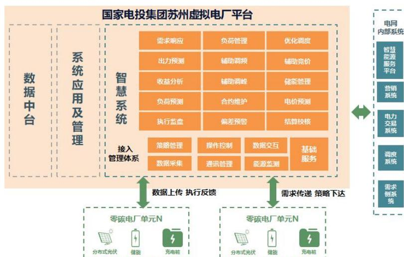
图 1 虚拟电厂平台架构设计
